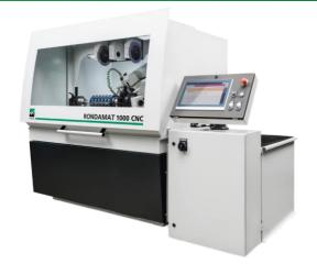
Die speziell auf den Rondamat 1000 entwickelten Schleifscheiben sind als CBN- oder Diamantschleifscheiben erhältlich. Hierbei wird unterschieden, ob Profilmesser, gerade Messer oder Profilmesser mit einer hohen Zähnezahl geschliffen werden.
